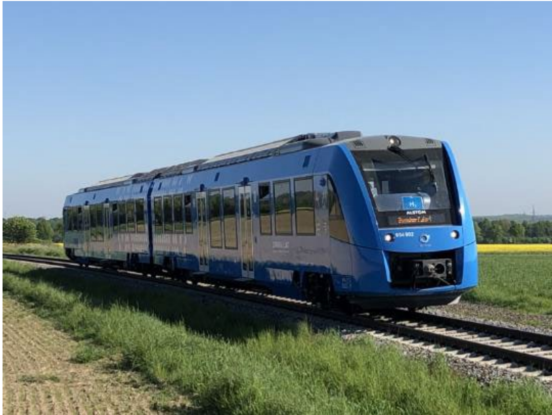
Alstom iLint Hydrogen train
