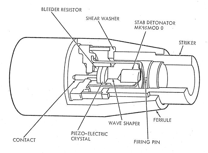
FIGURE 23. ROCKEYE II IMPACT SENSING ELEMENT
