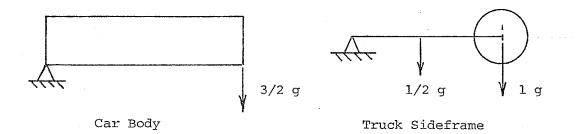
FIGURE D-1. FREE FALL GEOMETRIES
