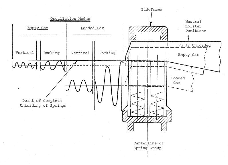
FIGURE 18. EMPTY AND LOADED CAR OSCILLATION MODES
