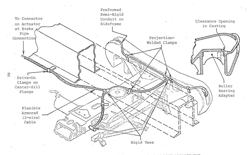
FIGURE 29. ELECTRIC ON-CAR COMMUNICATION LINK-ARRANGEMENT
