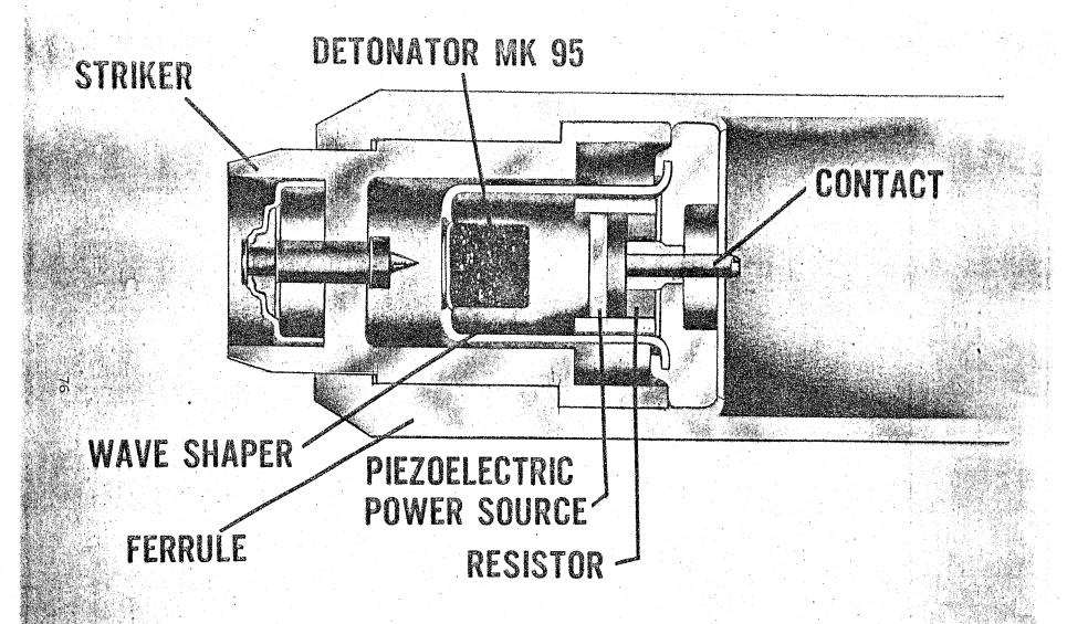
FIGURE 24. IMPACT SENSING ELEMENT ASSEMBLY FOR FUZE, BOMB, FMU-74/B
