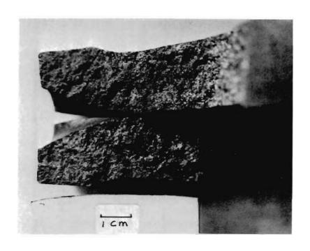
FIGURE 6. CRACK SURFACE OF KNORR NEAR INNER RADIAL EDGE. THE BRAKING SURFACE IS THE TOP EDGE OF THE UPPER PART AND THE BOTTOM EDGE OF THE LOWER PART. THE REGION TO THE LEFT LACKING LUSTER IS THE ORIGINAL CRACK SIZE; THE REST OF THE CRACK SURFACE IS FROM THE OPENING OF THE CRACK. THE DEPRESSION THAT FORMS ON THE BRAKING SURFACE IS A RESULT OF WEAR.
