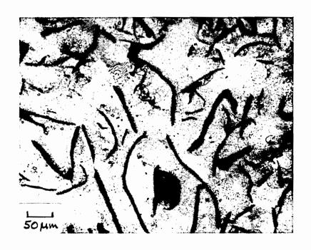
FIGURE 16. MICROSTRUCTURE OF WABCO DISC BRAKE TANG. THE SAMPLE WAS TAKEN NEAR THE HOLE SURFACE. MAGNIFICATION 560X.
