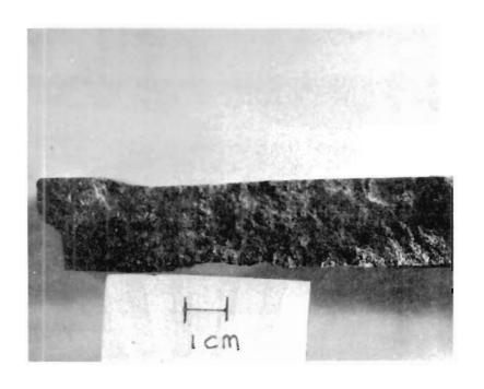
FIGURE 7. CRACK SURFACE OF KNORR MAJOR CRACK. THE DARK REGION IS THE CORRODED AND WORN AREA. THE UPPER EDGE IS THE BRAKING SURFACE. NOTE THE WEAR DEPRESSION.
