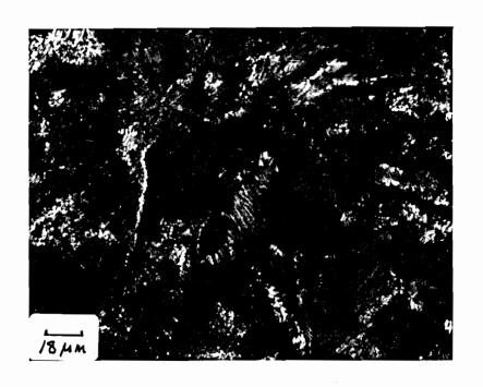
FIGURE 18. MICROSTRUCTURE OF WABCO DISC BRAKE FROM DISC SURFACE REGION. MAGNIFICATION 200X.
