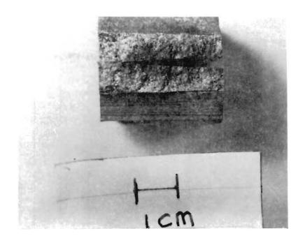
FIGURE 4. WABCO DISC BRAKE HEAT CHECK CRACK. THE CRACK WAS OPENED TO REVEAL THE CRACK SURFACE. THE DARK REGION IS THE CRACK, THE BRIGHTER REGION IS THE REGION FRACTURED TO OPEN THE CRACK. THE DARK MATERIAL IS CORROSION PRODUCTS.
