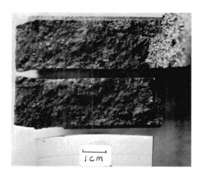
FIGURE 9. WABCO MAJOR CRACK NEAR THE OUTER RADIAL EDGE. THE DARK MATERIAL IS THE CORRODED AND WORN REGION. THE BRAKING SURFACES ARE THE MIDDLE EDGES. THE DEPRESSION IN THE BRAKING SURFACE IS A RESULT OF WEAR.
