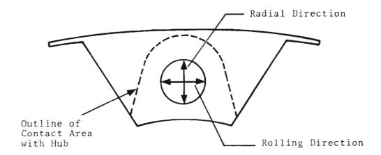
FIGURE 12. DIAGRAM OF WABCO DISC BRAKE TANG
