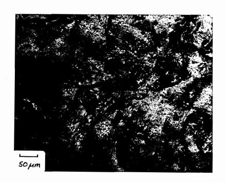
FIGURE 14. MICROSTRUCTURE OF WABCO DISC BRAKE. THE SAMPLE WAS TAKEN NEAR THE INNER RADIAL EDGE. MAGNIFICATION 200X
