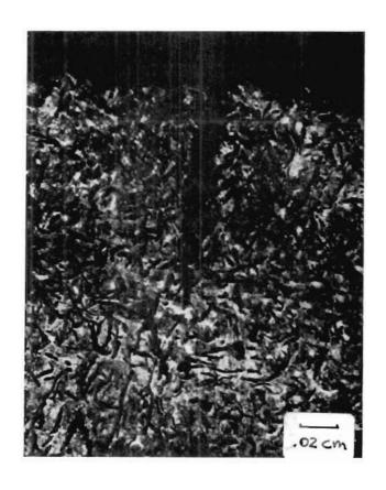
FIGURE 5. CROSS SECTION OF HEAT CHECK IN KNORR DISC BRAKE. THE MAGNIFICATION IS 50X. THE BLACK SEGMENTS IN THE METAL ARE THE GRAPHITE FLAKES.
