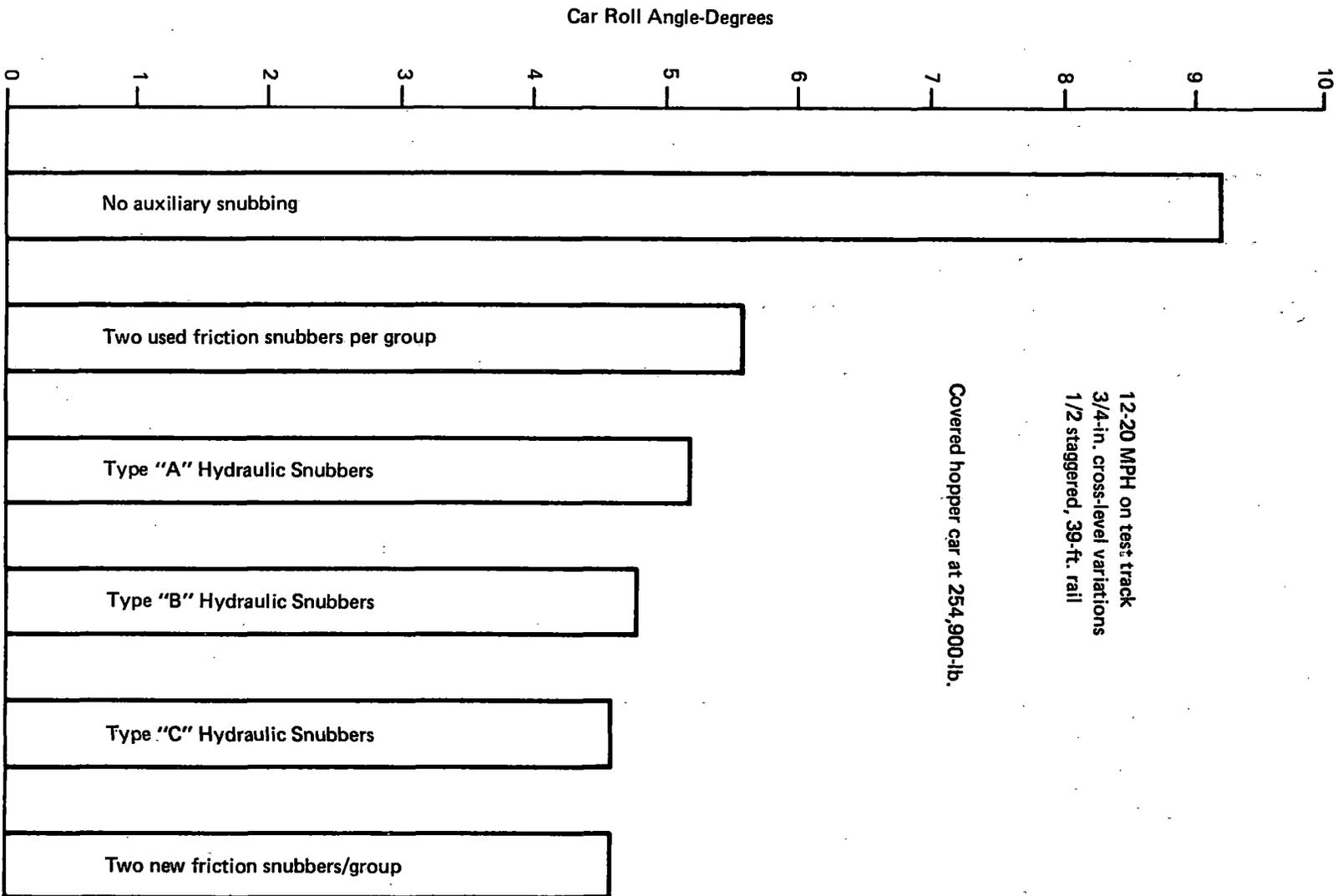
FIGURE F-3 EFFECT OF SNUBBING ON MAXIMUM CAR ROLL ANGLE
