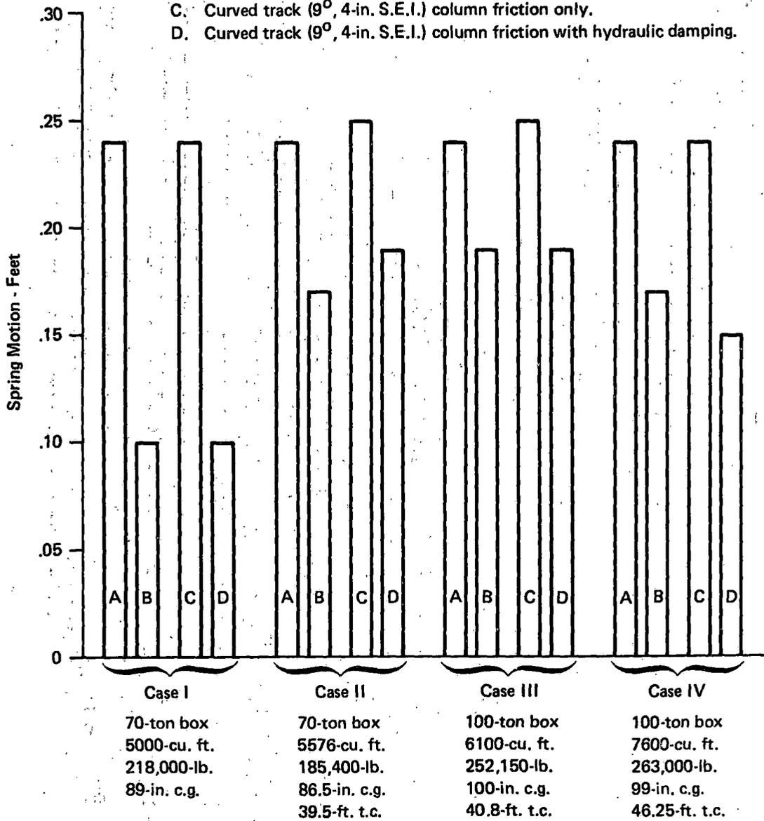
FIGURE F-7 EFFECT OF SNUBBING ON SPRING MOTION
