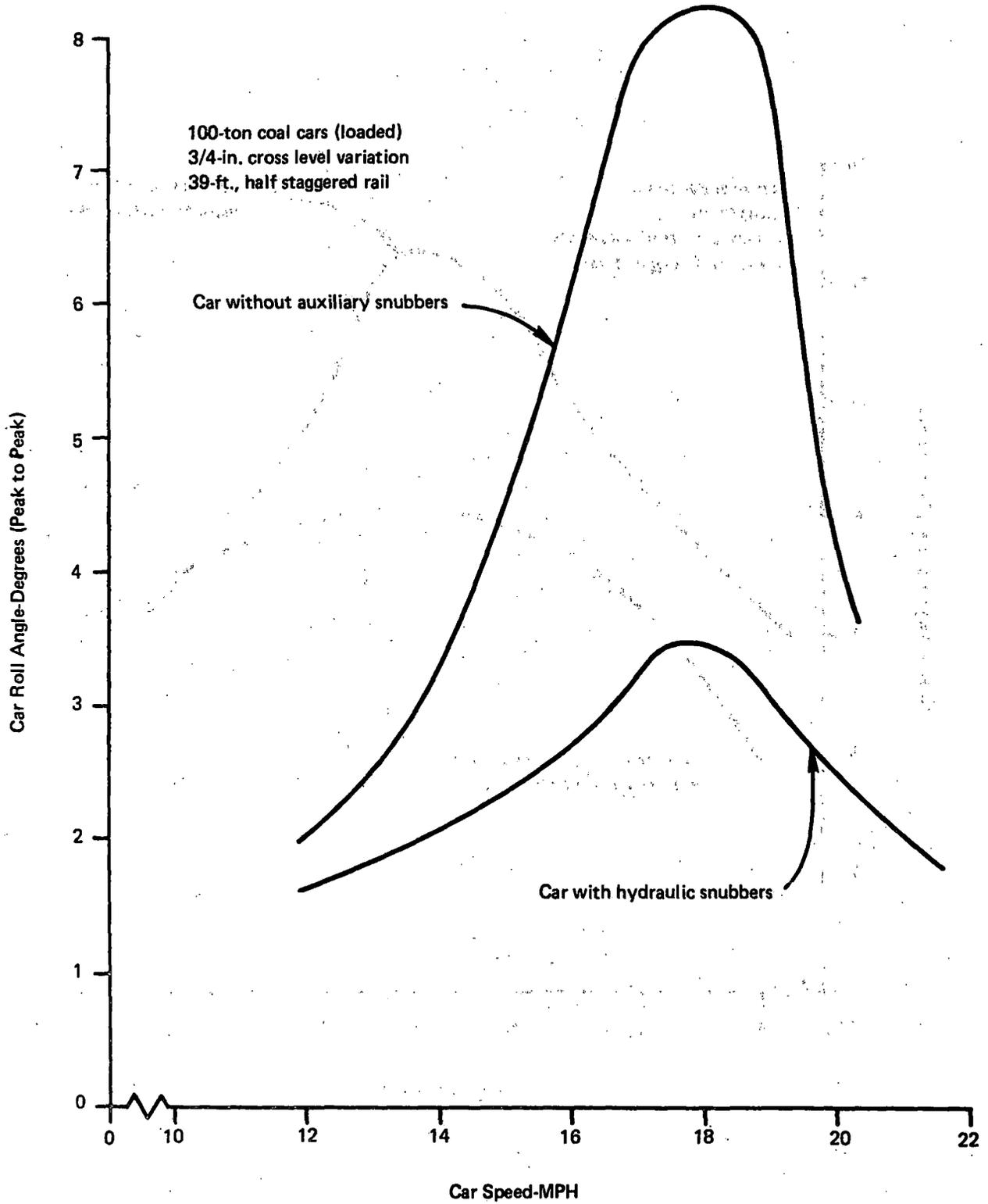
FIGURE F-1 EFFECT OF HYDRAULIC SNUBBING ON MAXIMUM CAR ROLL ANGLE
