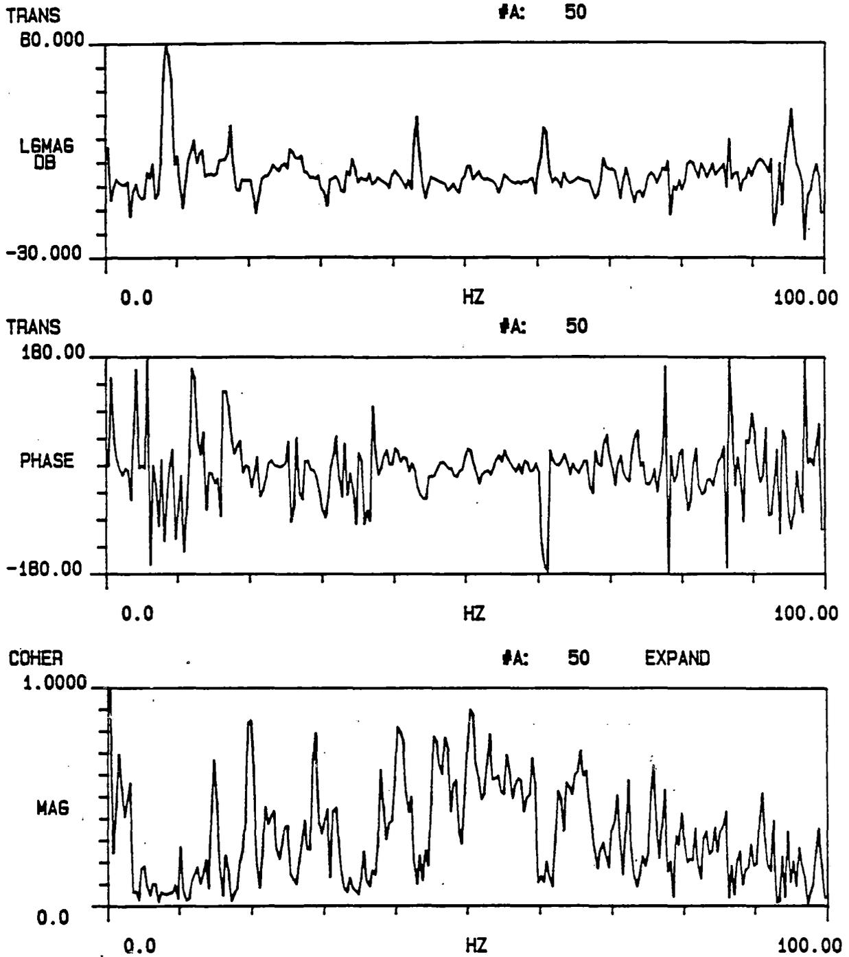
FIGURE 3.28 CAR BODY/BALLAST VERTICAL ACCELERATION
