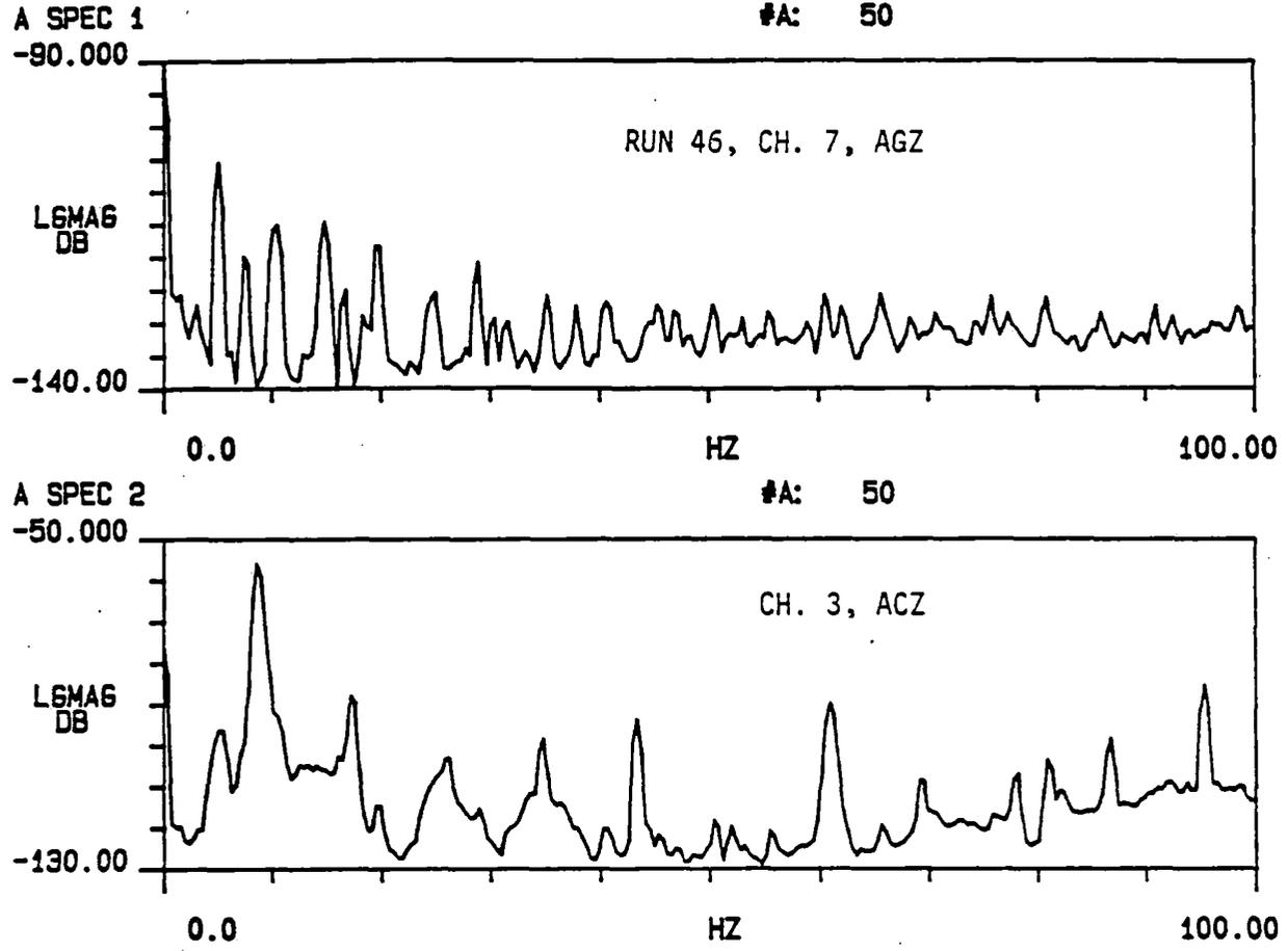
FIGURE 3.27 BALLAST AND CAR BODY VERTICAL ACCELERATION SPECTRA OVER 0-100 HZ BANDWIDTH (HP 5420A)
