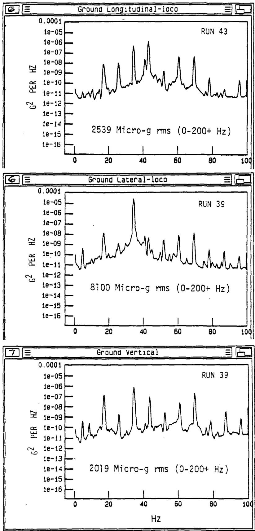
FIGURE 3.18 BALLAST ACCELERATION PSDs UNDER U30C TRAILING LOCOMOTIVE AXLE, NOTCH 8, BUNCHED COUPLERS
