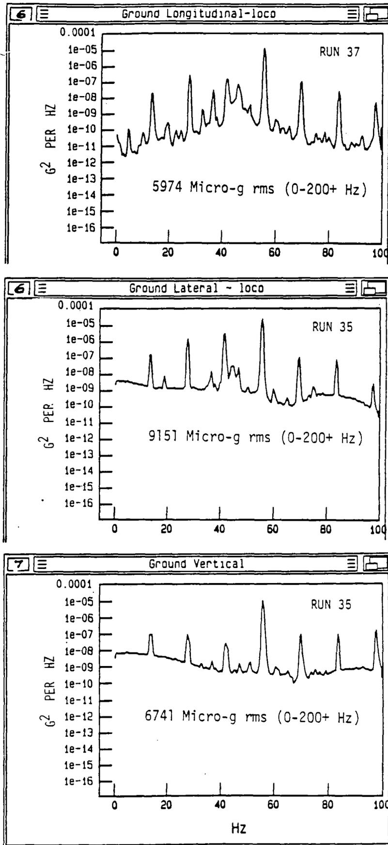
FIGURE 3.17 BALLAST ACCELERATION PSDs UNDER GP9 TRAILING LOCOMOTIVE AXLE, NOTCH 8, BUNCHED COUPLERS
